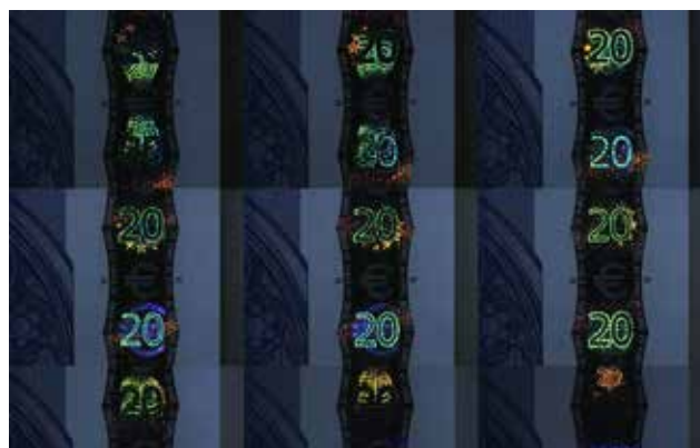
Последовательный ряд кадров при визуализации кинеграммы с голографическим эффектом (OVD) на банкноте 20 евро (изображение получено при помощи VSC6000/HS)
