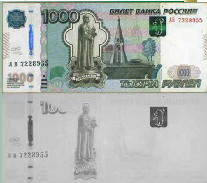
Метамерные краски на банкноте 1000 рублей: а – банкнота при обычном освещении, б – банкнота под воздействием ИК-излучения (изображения получены при помощи VSC6000/HS)
