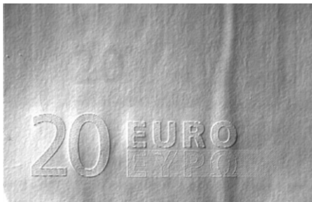
Визуализация защитного признака интаглио на банкноте 20 евро при помощи ИК-излучения (изображение получено при помощи VSC6000/HS)
