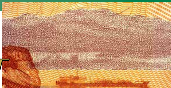
Изображение дальнего берега р. Амур на банкноте 5000 рублей, образованное мелкими графическими элементами (изображение получено при помощи VSC6000/HS)
