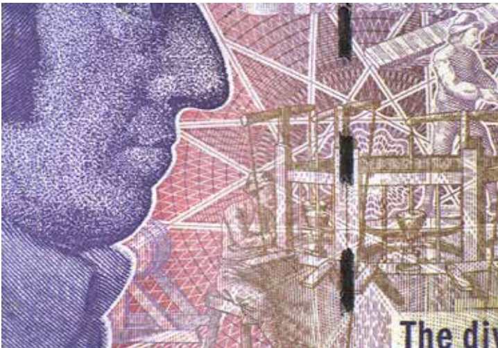
Увеличенное изображение нового «радужного» (rainbow) защитного элемента на банкноте 20 фунтов стерлингов (изображение получено при помощи VSC6000/HS)
