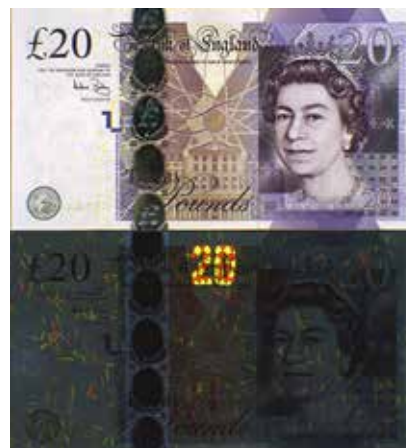
Проявление флюоресцирующего защитного признака в видимом свете и УФ-свете длиной 365 нм на банкноте 20 фунтов стерлингов (изображения получены при помощи VSC6000/HS)
