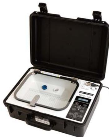
Переносная окуривающая камера с замкнутой системой очистки. Размещена в прочном, пылевлагозащищенном корпусе. MVC lite сохраняет все особенности полноразмерной окуривающей камеры и может быть использована на местах происшествия для выявления следов с помощью цианакрилата или Полициано.
