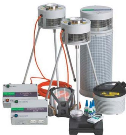
Переносная окуривающая цианакрилатовая система для выявления скрытых следов рук на различных объектах внутри замкнутого помещения непосредственно на месте преступления.
